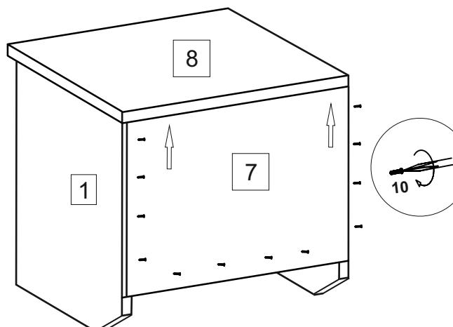
ДВП 7 предварительно вставить в паз крышки 8, а затем закрепить шурупом 10.
