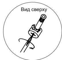
**Схема соединения болта с эксцентриком :**
