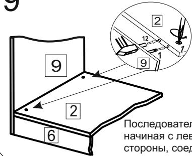
Последовательно, начиная с левой стороны, соединять детали корпуса стягивая между собой установленной фурнитурой.
