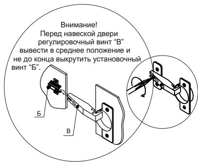
!!! На двери 12 , имеющие крайние расположение в шкафу, установить петли 45 и закрепить их на боковине 9 шуруп 10
